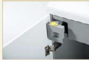
Integrierter Öltank für eine geregelte, automatische Ölung der Walzen.
