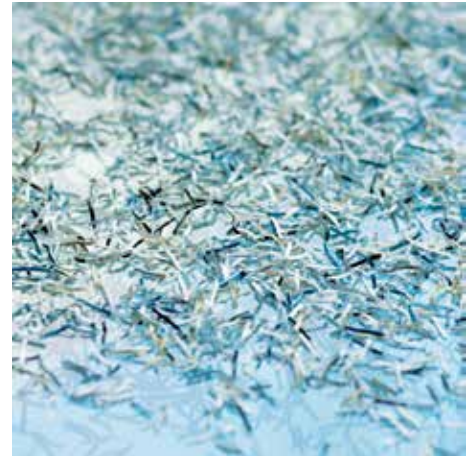
Sicherheitsstufe P-6: Empfohlen für Datenträger mit geheim zu haltenden Daten, wenn außergewöhnlich hohe Sicherheitsvorkehrungen einzuhalten sind
